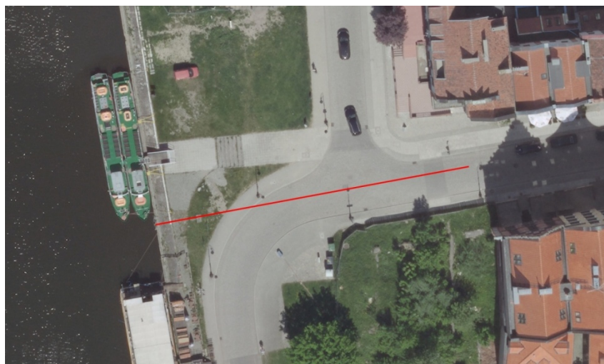
Rys. 1. Profil pomierzony w terenie metodą GPS RTK służący jako odniesienie do oceny dokładności badanych chmur punktów
