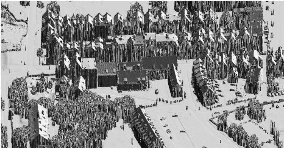
Rys. 13. Numeryczny model pokrycia terenu wygenerowany na podstawie chmury punktów LiDAR o gęstości 10 pkt/m 2
