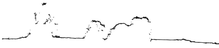
Rys. 8. Profil przez teren zadrzewiony, chmura punktów SGM, kamera DMC I, GSD 10 cm, stosunek bazowy 0.15, okres wegetacji
