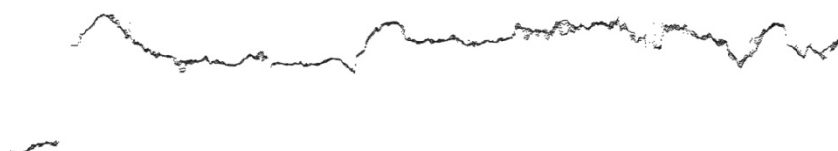
Rys. 6. Profil przez teren zabudowany, chmura punktów SGM, kamera DMC II 230, GSD 15 cm, stosunek bazowy 0.17
